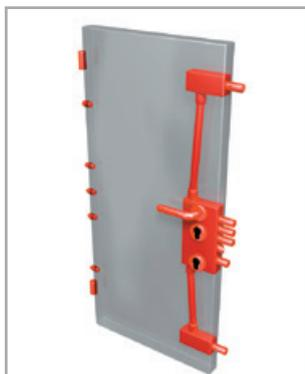
Serratura di sicurezza per cilindro a Profilo Europeo e serratura di servizio con cilindro. Versioni standard ad un' Anta.
